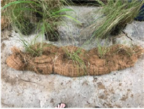
Figura 1. Fotografía de biorrollo hecho con geomanta de fibra de coco cortada en rectángulo, rellena con compost y tierra, arrollada y sembrada encima con plantas para humedales tipo juncos.
